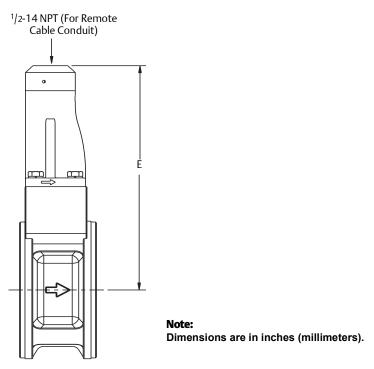
Table A-15. Rosemount 8800D Wafer-Style Meter
